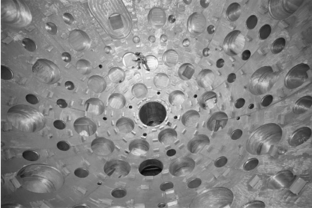
Vaughn Draggoo inspeciona uma imensa câmara-alvo no NIF, na Califórnia, local de testes para fusão nuclear induzida por luz. Feixes de 192 lasers serão apontados para uma cápsula de combustível de fusão para produzir uma explosão termonuclear controlada (2001).
