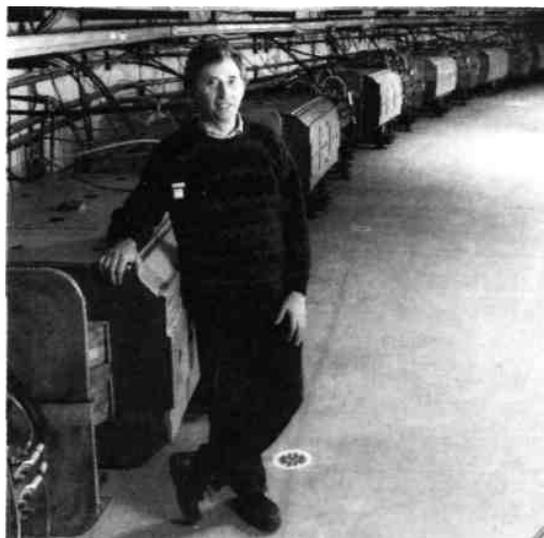
John Peoples, diretor do Fermilab, junto à fonte antipróton que desenhou. Os antiprótons produzidos pela colisão de prótons contra um alvo de lítio são armazenados num feixe circular, utilizando-se o conjunto de magnetos mostrado na foto. *(Foto Fermilab)*
