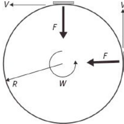
FIGURA 5.03: Fatores que compõem o movimento de um bumerangue.  $F$  é a força criada pela sustentação,  $V$  é a velocidade com que o centro do bumerangue se move,  $R$  é o raio da trajetória do bumerangue, e  $W$  é a taxa de precessão.
