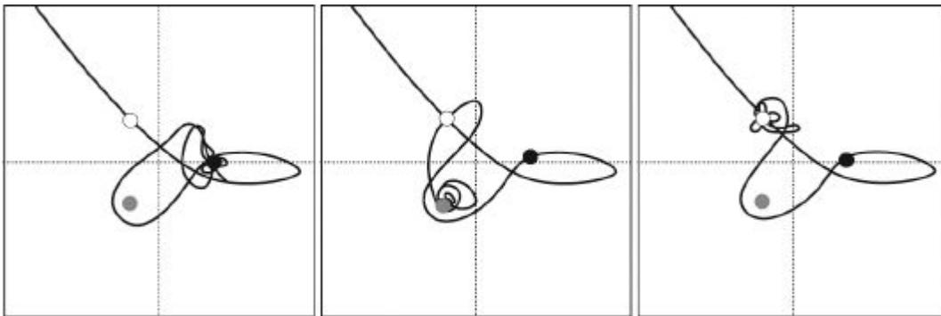
FIGURA 5.06: Uma pequena mudança na posição inicial do pêndulo pode levá-lo a percorrer uma trajetória totalmente diferente entre os três ímãs (mostrados como pequenos círculos: branco, cinzento e preto).
