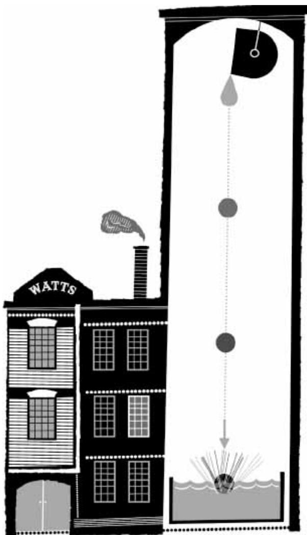
FIGURA 2.01: Uso inteligente da natureza feito por William Watts para produzir rolamentos esféricos.
