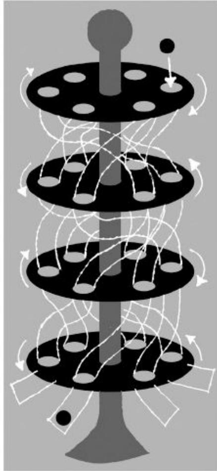
FIGURA 4.02: O princípio da máquina Enigma: deixe cair uma bola pelos tubos para codificar uma letra. Os cilindros giram um atrás do outro, após cada codificação, de modo que as letras se misturam, cada vez, de uma outra maneira.
