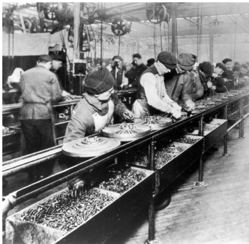
A primeira linha de montagem móvel de Henry Ford, instalada em 1913. Ela usava as técnicas de “administração científica” de Frederick Taylor para aumentar o ritmo da produção de automóveis.
