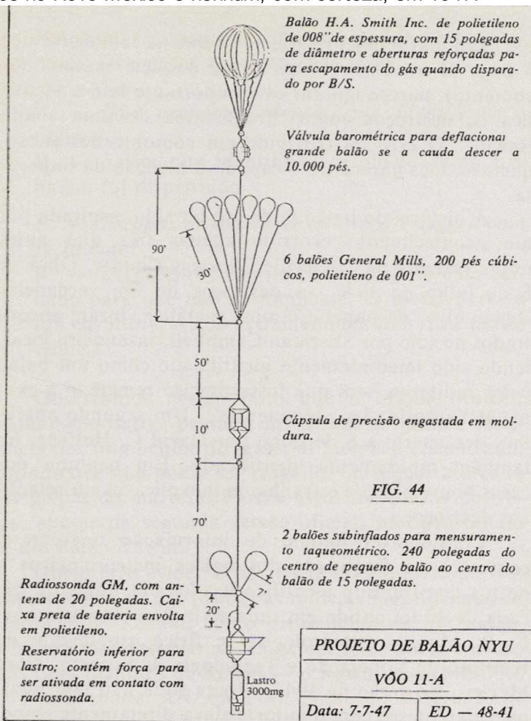
*Diagrama do tipo de balões para sondagem atmosférica lançados na Base Aérea de Alamogordo, Novo México, à época da queda do disco voador, julho de 1947. Este diagrama refere-se ao vôo 11-A, lançado a 7 de julho de 1947. Embora esses balões sejam com frequência confundidos com OVNI's quando no ar, é difícil aceitar uma confusão em terra.*
