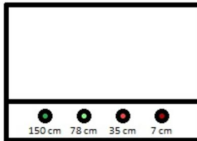
Existem muitos sensores que vem com telas, mas essas telas não mostram a distância de cada sensor à objetos, essas telas só mostram a distância do sensor que tem um objeto mais perto, e essas telas ficam em cima do painel, quando o motorista dá ré, o motorista não olha para o painel, o motorista olha para o retrovisor.
