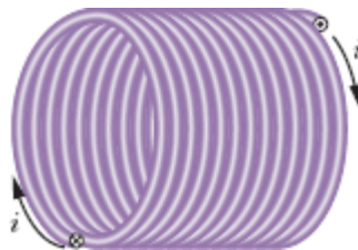
Figura 29-17 Um solenoide percorrido por uma corrente i .
