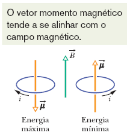
Figura 28-20 Orientações de maior e menor energia de um dipolo magnético (no caso, uma bobina percorrida por corrente) na presença de um campo magnético externo \vec{B} . O sentido da corrente i determina o sentido do momento dipolar magnético \vec{\mu} por meio da regra da mão direita mostrada para \vec{n} na Fig. 28-19b.
