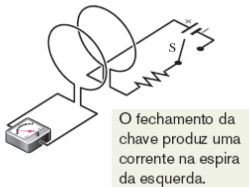
Figura 30-2 Um amperímetro revela a existência de uma corrente no circuito da esquerda quando a chave S é fechada (fazendo circular uma corrente no circuito da direita) ou quando a chave S é aberta (fazendo com que a corrente no circuito da direita seja interrompida), mesmo que a posição relativa das espiras não mude durante o processo.
