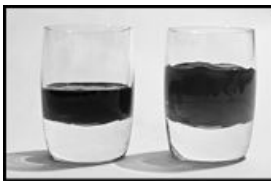
Crua: não pressurizada (esquerda) e pressurizada (direita).
