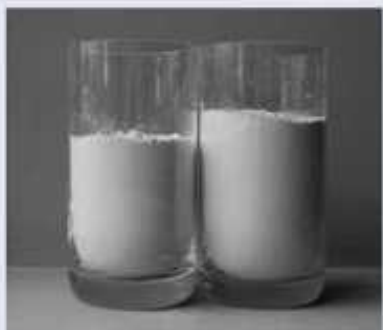
Quanto de farinha existe em uma xícara? Depende se ela está compactada (na esquerda: 1 xícara com 156 gramas, e depois peneirada) ou solta (na direita: 1 xícara com 125 gramas e depois peneirada).
