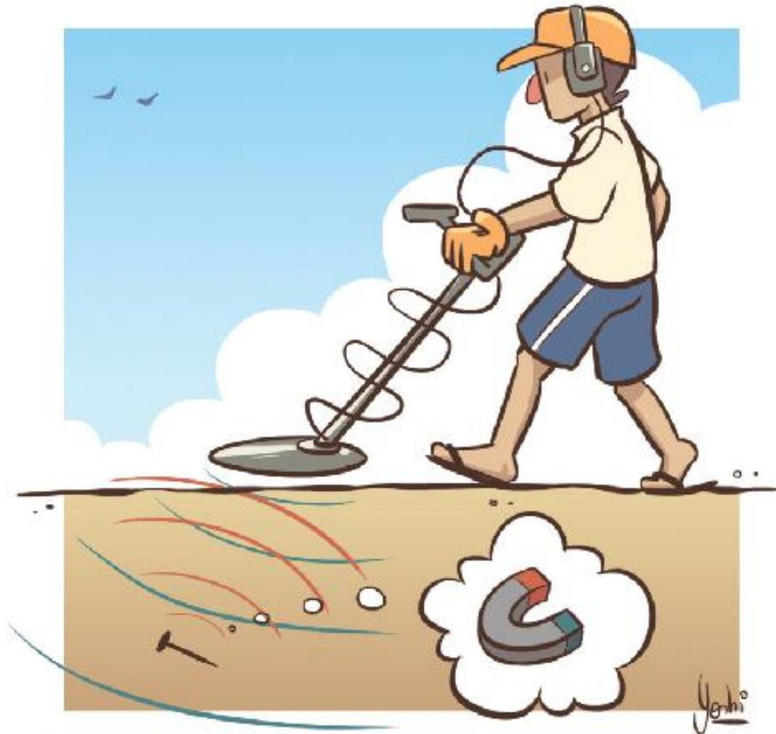
Para entender de verdade como funciona, é importante conhecer um fenômeno físico muito interessante, a indução eletromagnética. Quando um ímã se movimenta perto de qualquer material condutor de eletricidade, como um fio de cobre, ele gera corrente elétrica (sim, surge eletricidade no fio!). É exatamente assim que os geradores funcionam.
