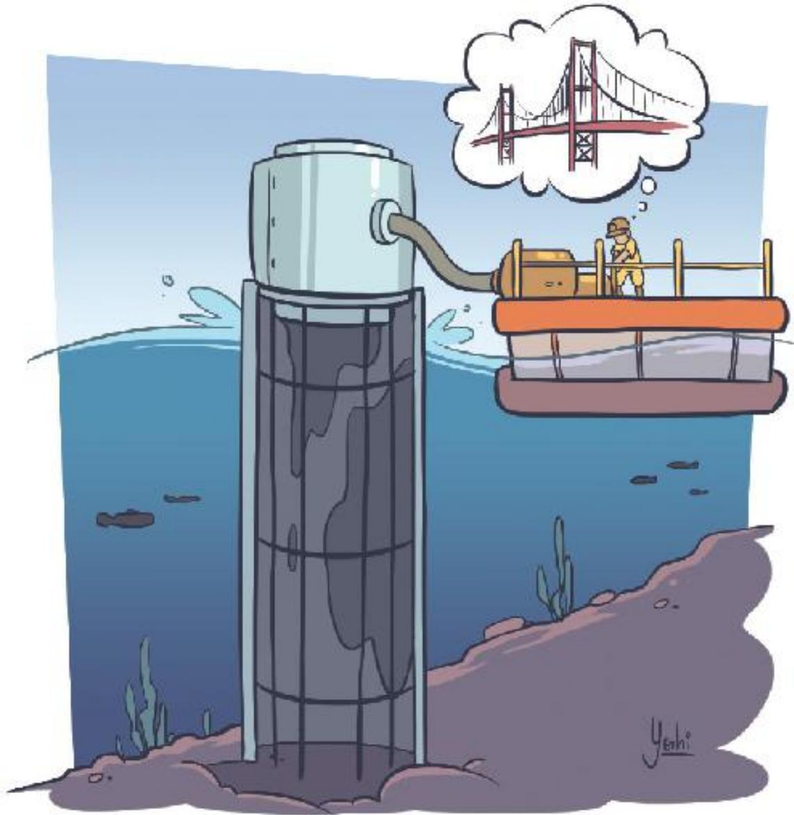
A instalação dos tubulões envolve uma operação complexa, que necessita de muitas máquinas e trabalhadores. Ficam todos acomodados em uma balsa, no exato local onde se deseja construir o futuro pilar. A peça de aço, então, é posicionada e começa a ser submersa. Só que um pilar não pode estar “recheado” de água, ou seja, o “canudão” de aço precisa expulsar a água e, assim, manter seu interior seco. Para que isso aconteça, enquanto o tubo desce até o fundo do mar, ar
