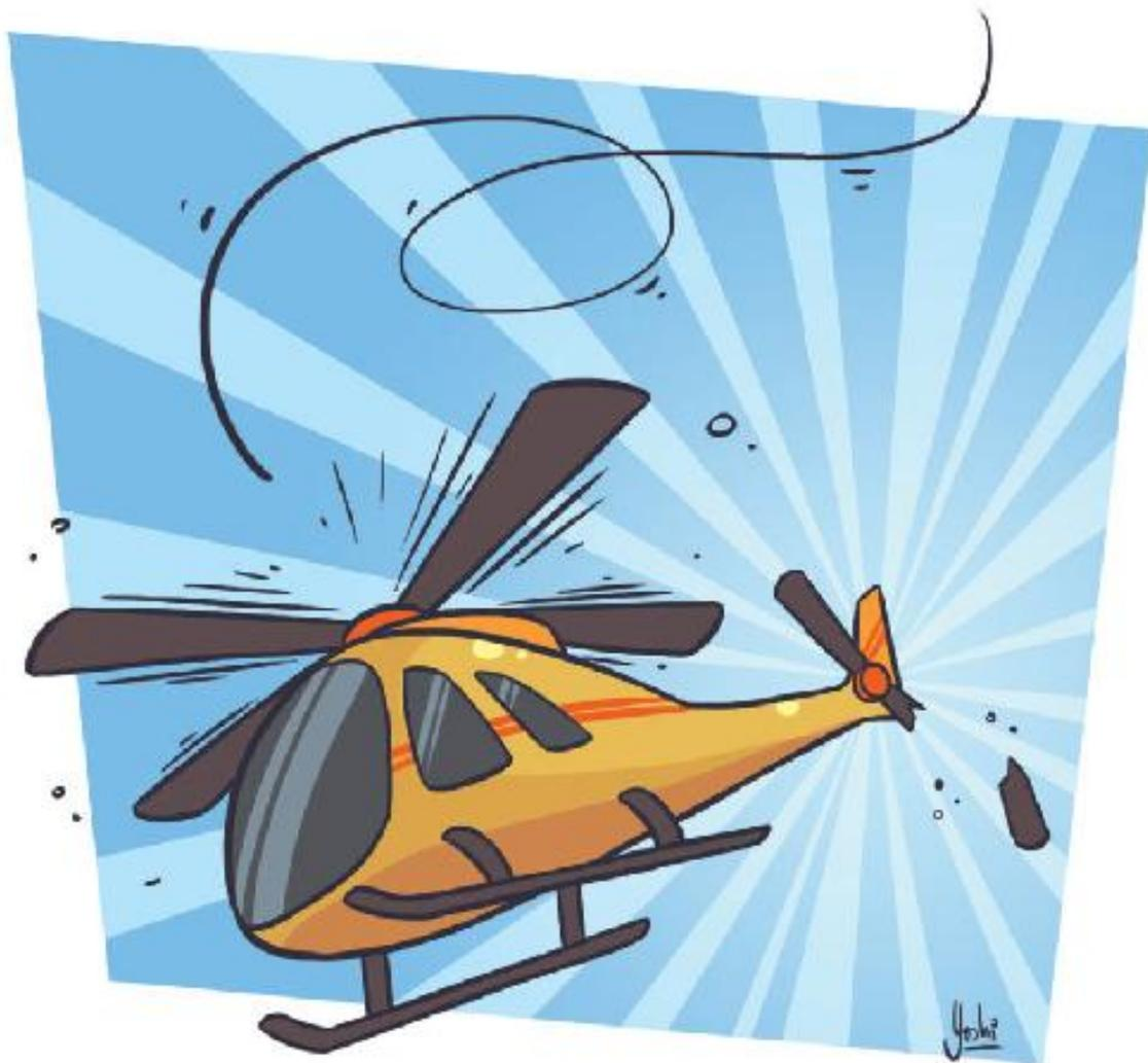
O rotor de cauda impede esse rodopio. Ele empurra o ar na direção contrária à que o helicóptero tende a girar, estabilizando a aeronave.
