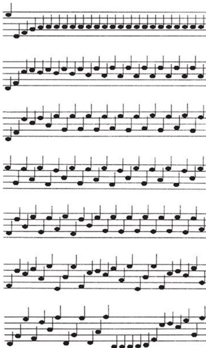
FIGURA 62. Representação esquemática das iterações de um mapeamento logístico x \rightarrow kx(1 - x) em notação “musical”. A altura das “notas” representa o valor de x , e a “pauta” foi desenhada arbitrariamente. A constante k é (de cima para baixo) 2, 3, 2, 3,5, 3,53, 3,6, 3,8, 4,0. Quanto maior for k , mais a música se torna randômica em qualidade.
