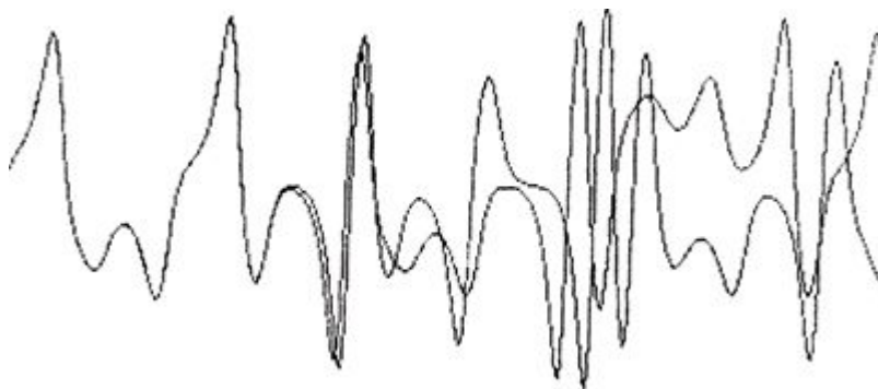
FIGURA 57. O efeito borboleta: simulação numérica de uma variável no sistema de Lorenz. As curvas representam condições iniciais que diferem em apenas 0,0001. De início elas parecem coincidir, mas logo a dinâmica caótica leva a trajetórias independentes, muito divergentes.
