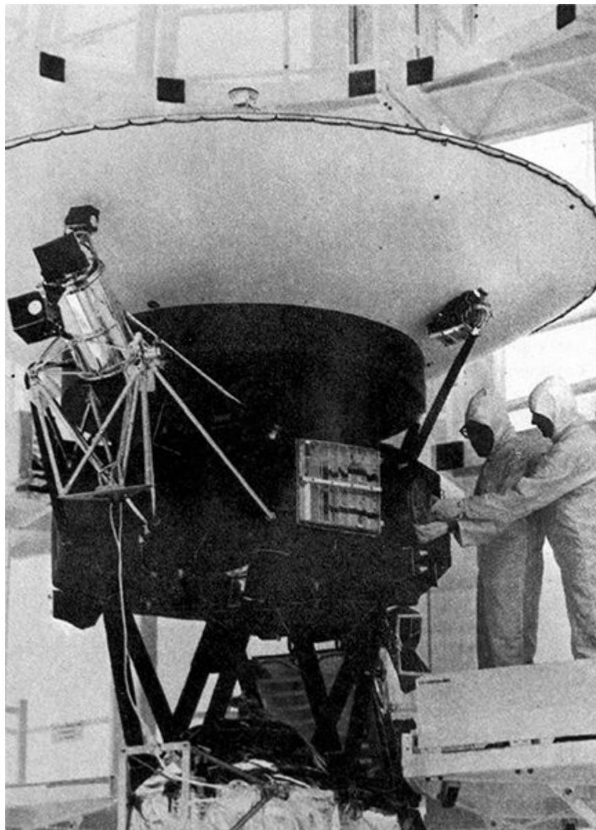
FIGURA 81. Técnicos montando o disco gramofônico na *Voyager 2*.
