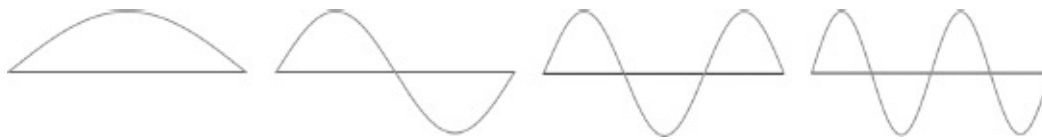
FIG 124 Da esquerda para a direita: Meia onda senoidal. Onda senoidal completa. Uma onda senoidal e meia. Duas ondas senoidais.
