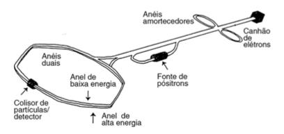
O ACELERADOR LINEAR DE STANFORD O Acelerador Linear (LINAC) usa o canhão de elétrons para liberar elétrons de uma fonte de metal aquecido na pista de 3,2 quilômetros em que as partículas são aceleradas e injetadas nos anéis duais.
