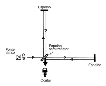
EXPERIMENTO MICHELSON-MORLEY A luz proveniente da fonte é dividida pelo espelho semirrefletor e se desloca ao longo de dois braços perpendiculares. Espelhos em cada extremidade refletem os feixes de luz. Os resultados negativos desse experimento indicam que o vento do éter não existe.
