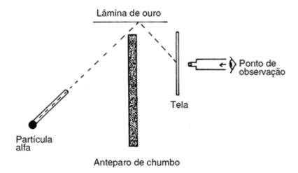
EXPERIMENTO DE RUTHERFORD PARA PROVAR A EXISTÊNCIA DO NÚCLEO ATÔMICO Algumas partículas alfa disparadas contra uma fina lâmina de ouro são defletidas para a tela em vez de atravessar a lâmina.
