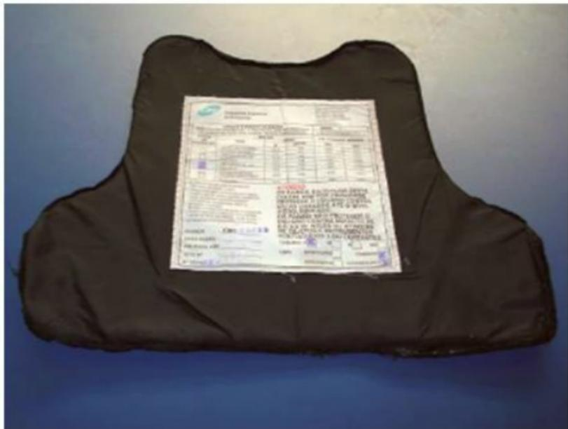
Figura 65. Capa interna do painel balístico, com a etiqueta de informações técnicas.
